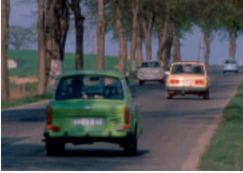
Willem Böttger (NPSP Composieten): 'De Trabant was een innovatie die uit nood ontstond wegens een tekort aan staal.' De carrosserie was gemaakt van fenolformaldehyde/katoenvezel composiet. (foto Ruud Kampf)
